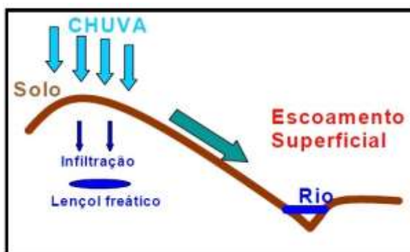
Figura 7 – Esquema do escoamento superficial em solo sem cobertura vegetal.
