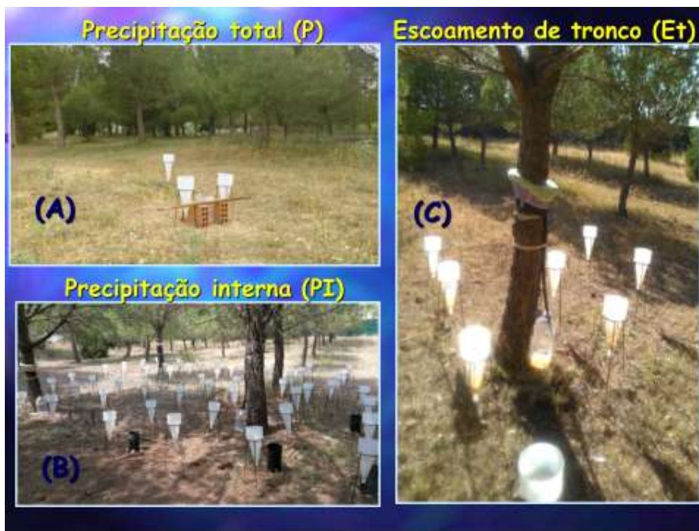
Figura 1. Pluviômetros de quantificação da precipitação total (P) precipitação interna (PI) e coletor de água do escoamento pelo tronco (Et) em Pinus halepensis – Albacete – Espanha.
