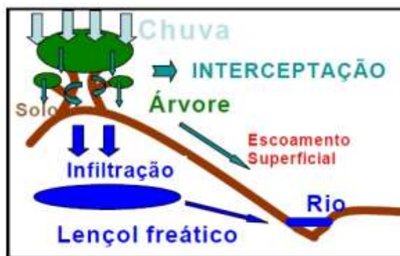
Figura 7 – Esquema do escoamento superficial em solo com cobertura vegetal. Segundo LIMA, 1999, a saúde da micro-bacia deve-se a perpetuação de seu funcionamento hidrológico, de seu potencial produtivo ao longo do tempo e da biodiversidade ao longo da paisagem.
