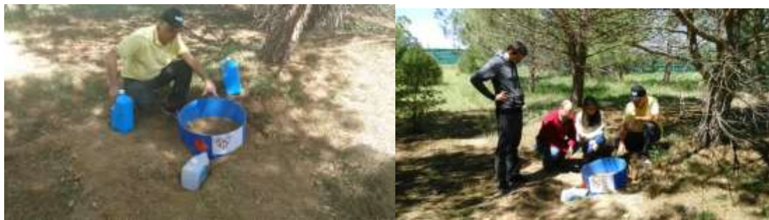
Figura 2. Infiltrômetro: infiltração da chuva, escoamento superficial e sedimentos do solo.
